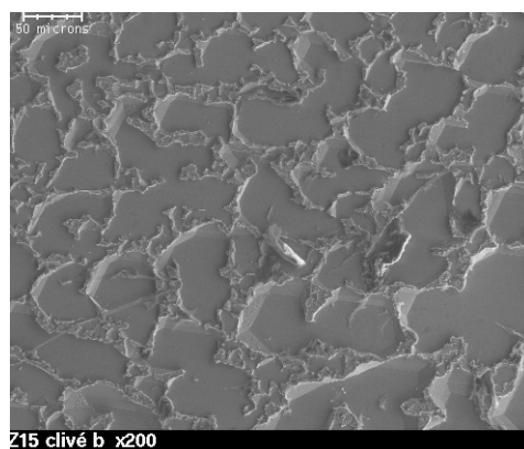
Fig. 2.2.4 : Caractérisation en microscopie à balayage (F. Roussel, CMTC) de l'échantillon CZ15 II clivé. La surface comporte des terrasses facettées dont la taille est de quelques dizaines de microns.
